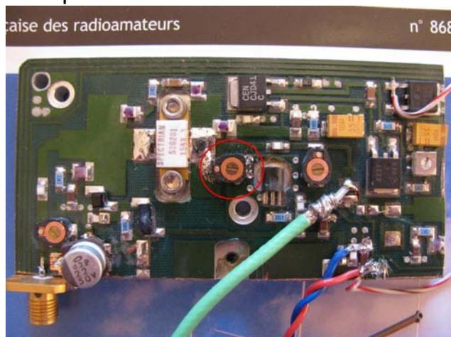
Monté avec le MRF 286 pour test
